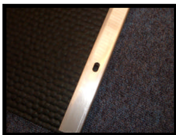
Billede 2 - Placer vinkeljernet på måttens forkant og bor huller i måtten (bor = 11 mm), således at de passer med hullerne i vinkeljernet og ristene. Bor tilsvarende huller ved måttens bagkant. (se billede 1)
