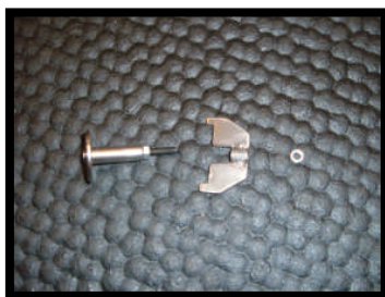
Billede 3 - Skru møtrikken i bunden af Quick-Lock-beslaget af og tag ankeret af.
